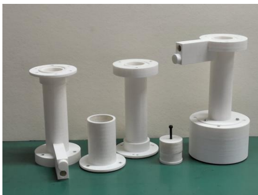
Figura 1: Piezas del tubo de impedancia construidas en impresora 3d.
