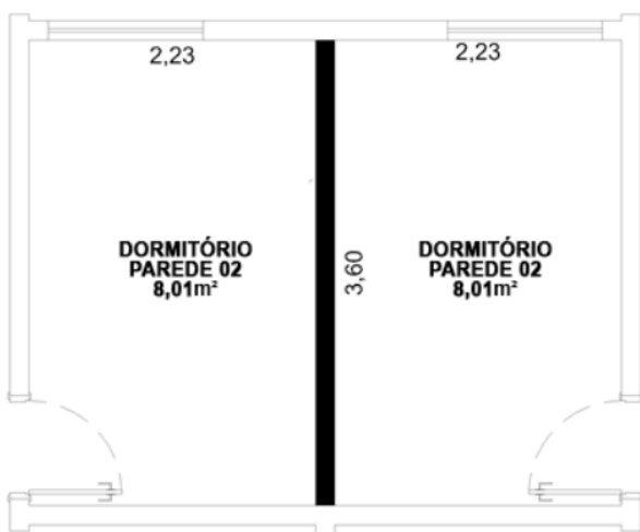
Figura 5 - Projeto do dormitório 02, com destaque na parede 02 com blocos estruturais preenchidos com agregado de concreto reciclado fino.
