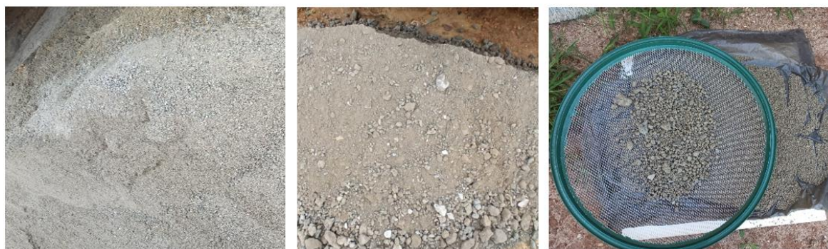
Figura 2 - Agregados de concreto reciclado utilizados no preenchimento dos blocos. Da esquerda para direita, agregado fino (a), agregado grosso (b) e agregado em peneiramento (c).
