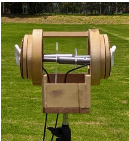
Figura 2: Prototipo para registro de audio binaural implementado
