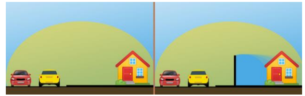
Figura 1: Ilustração do efeito causado pela inclusão da barreira acústica em uma rodovia com ruído de tráfego representado pela região em amarelo.
