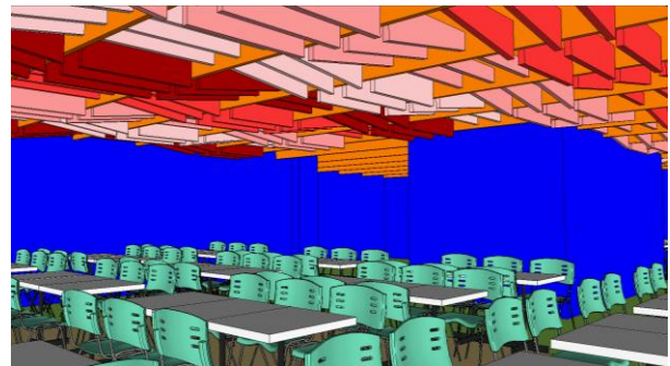
Figura 7: Proposta de intervenção com baffles trapezoidais.
