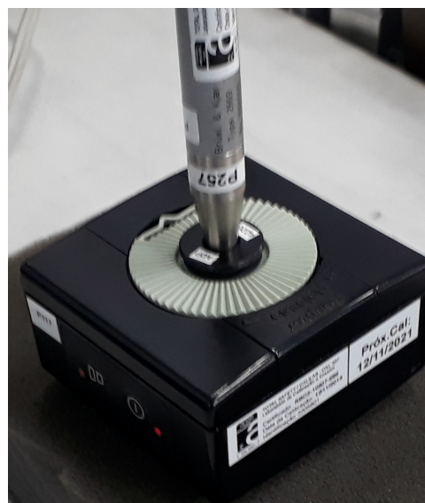
Figura 3 – Ajuste da sensibilidade do sistema de medição (+ Mic Gras 40BP) utilizando um calibrador de nível sonoro Bruel & Kjaer 4231
